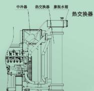
巧妙独创的冷却装置——利用水泵出口的水流，通过水 / 水热交换器和特殊设计的气 / 气冷气冷却器（涡轮增压机型应用），实现发动机系统的冷却。省却常规的冷却水管和风扇，令设备能耗降低、减少污染、体积小、可靠、易于维护。
